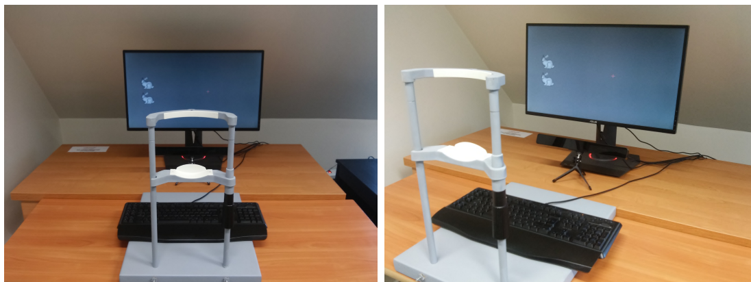
Rysunek 2.21. Stanowisko komputerowe, na którym odbywał się pomiar akceptowalnego opóźnienia systemu renderingu uwzględniającego kierunek patrzenia. W trakcie trwania eksperymentu oświetlenie stanowiska było wyłączane, jedynym źródłem światła był obraz pochodzący z wyświetlacza.
