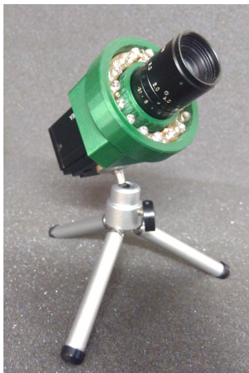
Rysunek 2.28. Eye tracker działający w wysokiej częstotliwości. Wydrukowana obudowa została stworzona pod konkretny model kamery. Kamera posiada uniwersalny otwór z gwintem, co pozwala ustabilizować ją na dowolnym statywie.
